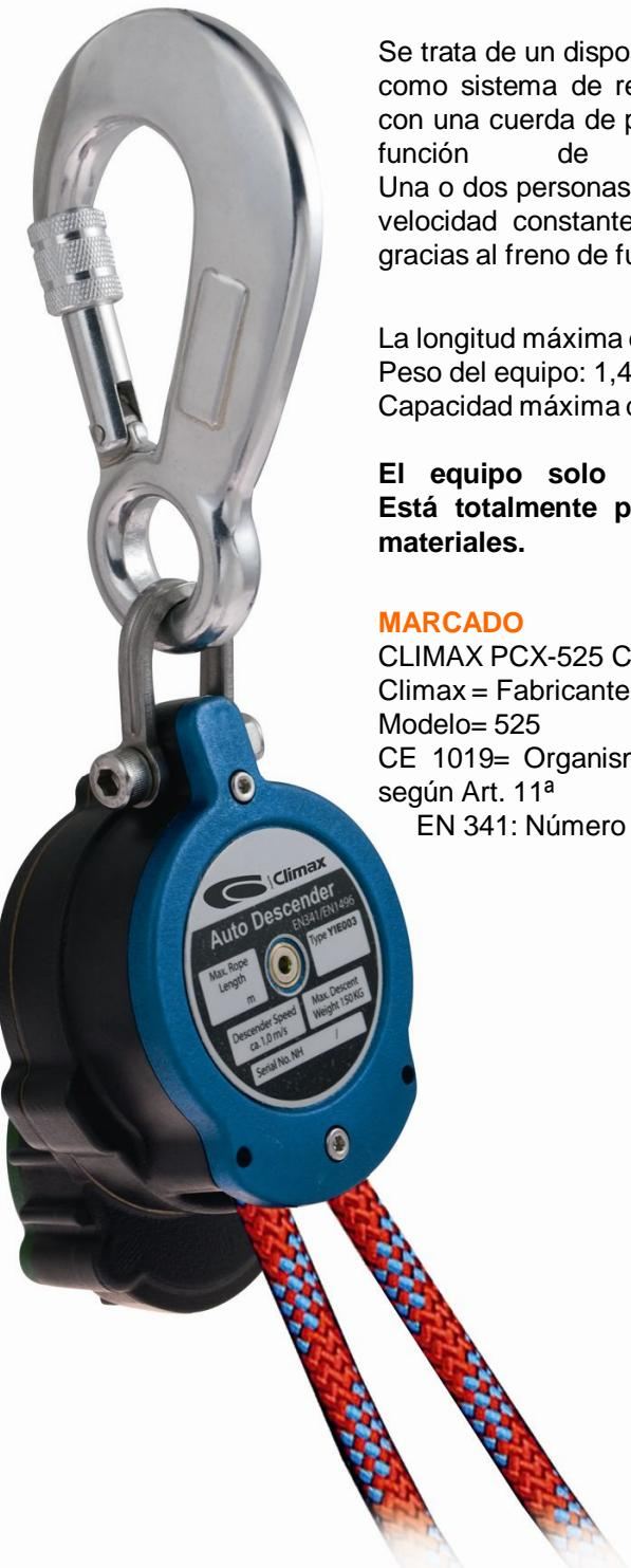
Se trata de un dispositivo de descenso automático de **clase A** diseñado como sistema de rescate y salvamento. El descensor está equipado con una cuerda de poliamida en 11 mm, y de una longitud variable, en función de las necesidades del usuario. Una o dos personas conectadas al dispositivo pueden descender a una velocidad constante de 0,8 m-1,50 m/seg. (dependiendo del peso), gracias al freno de fuerza centrífuga.
