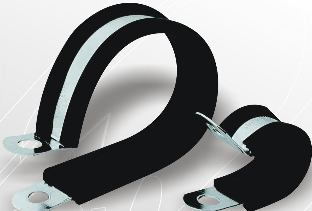
As abraçadeiras **Borracha** foram projetadas para fixação de tubos ou mangueiras em estruturas sujeitas a vibração. Sua cobertura de borracha EPDM proteje os componentes do contato direto entre eles, e seu furo oblongo permite uma montagem mais fácil. São utilizadas em caminhões, ônibus, automóveis e instalações industriais.
