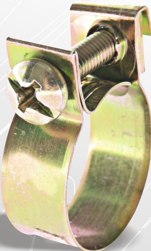
As abraçadeiras da linha **Simplex**, confeccionadas com fita de 0,4mm de espessura e 9mm de largura, possibilitam uma perfeita adaptação ao perfil da mangueira. Por sua concepção simples, porém eficiente, é indicada para uso em locais com baixa pressão.
